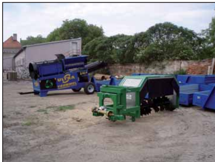
Osivačka kompostu a překopávač - rotavátor na prohnětení bioodpadu. Foto: OÚ Kvasice.
