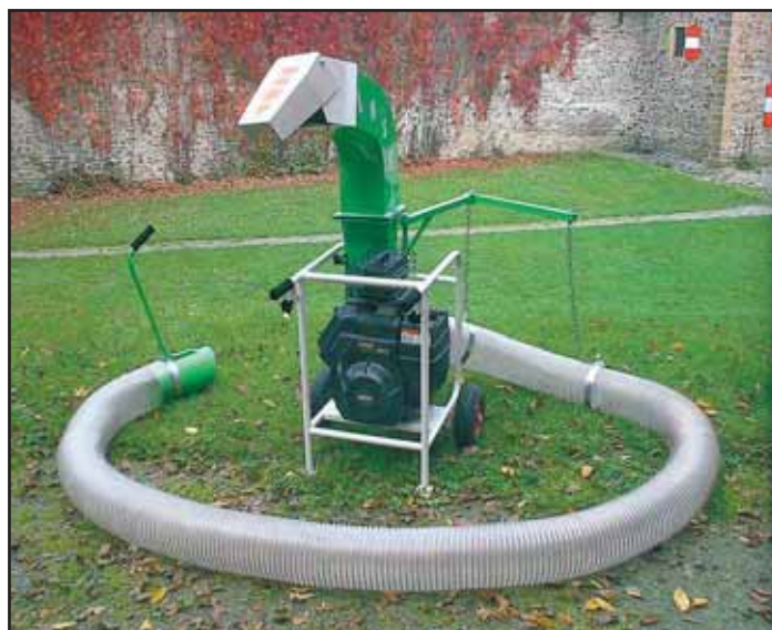
Vysavač na listí LASKI VD 440, který zakoupila obec. Je určen především k profesionálnímu sběru a nakládání komunálního odpadu, listí a trávy. Je robustní konstrukce, která mu zabezpečuje dlouhou životnost.
